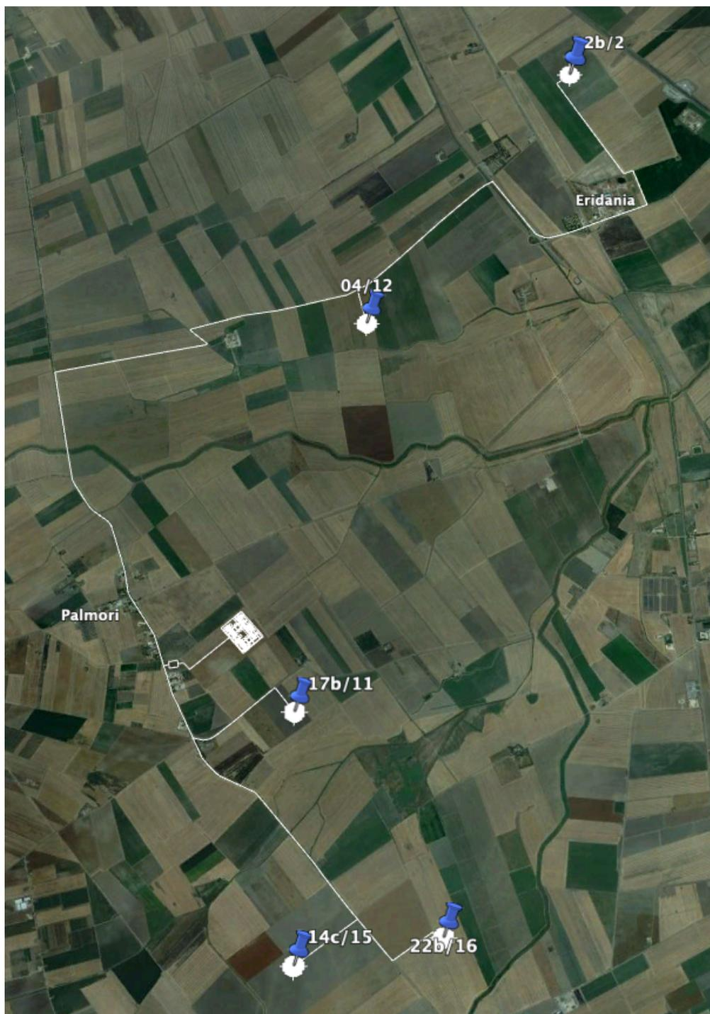
Per garantire una sufficiente elasticità ed indipendenza di esercizio, gli aerogeneratori sono collegati con cavi elettrici separati, garantendo così una continuità di servizio indipendente anche durante il fuori esercizio di uno solo per esigenze di manutenzione.
