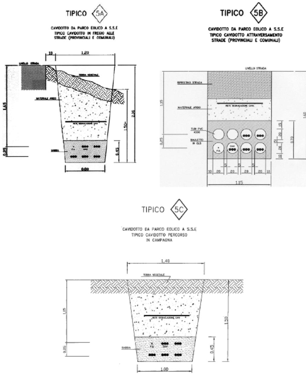
I cavi di potenza sono terne unipolari del tipo ARG7H1(AR)E-AIR-BAG in alluminio sezioni da 185 a 400mmq ed idonei anche alla posa direttamente
