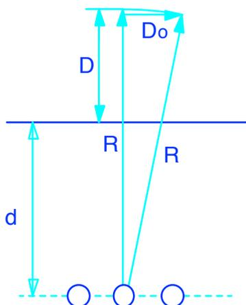
Inoltre con la relazione seguente può calcolarsi la distanza  $D_0$  in orizzontale dopo la quale il valore della induzione magnetica scende sotto i  $3 \mu\text{T}$ :
